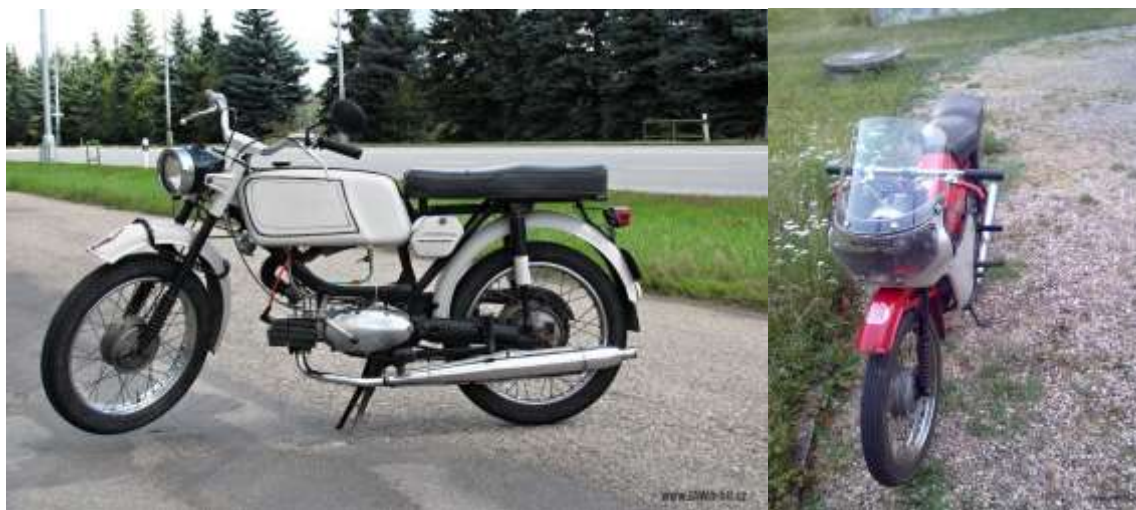
Vlevo bez kapotáže, vpravo s kapotáží.
